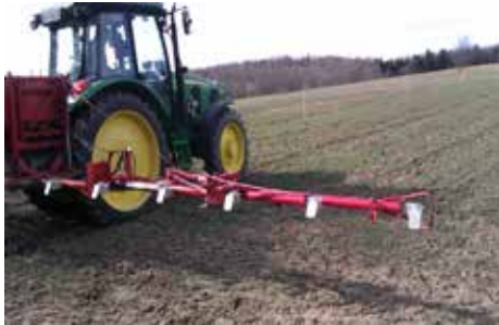
Der Einsatz eines pneumatischen Düngerstreuers war Voraussetzung für exakte Durchführung des Versuches. Der Winterweizen-Düngungsversuch im bei der Ernte im Juli (Kerndrusch der Parzellen)
